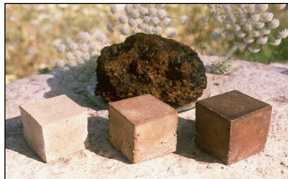
تصویر ۱۰. توده جامد ملاس و نمونه خشت‌های تثبیت شده با آن (مأخذ: نگارنده).
