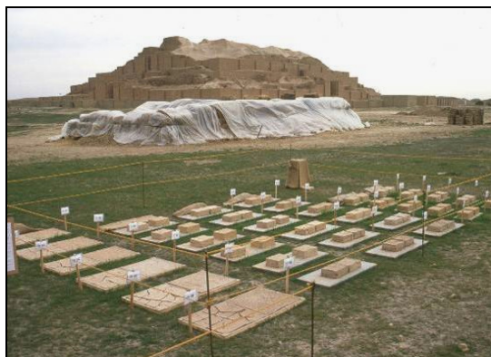
تصویر ۱۴ و ۱۵. بررسی نمونه‌های آزمایشی خشت در شرایط میدانی (مأخذ: نگارنده).
