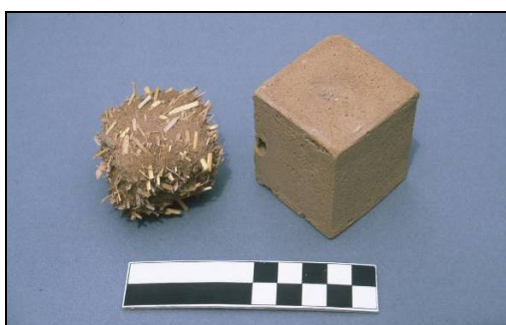
تصویر ۱۳. وضعیت نمونه تثبیت شده خشت (سمت راست) و نمونه تثبیت نشده خشت (سمت چپ) بعد از آزمون آب شستگی (مأخذ: نگارنده).
