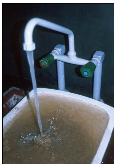
تصویر ۱۱. نمونه تثبیت نشده خشت در حین اجرای آزمون آب شستگی (مأخذ: نگارنده).
