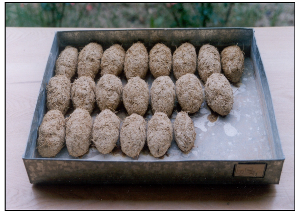
تصویر ۹. ساخت بریکت از باگاس و لجن آهک (مأخذ: نگارنده).
