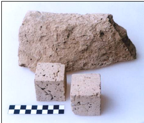
تصویر ۲. تهیه نمونه‌های مطالعاتی خشت از قطعه اصلی (مأخذ: نگارنده).
